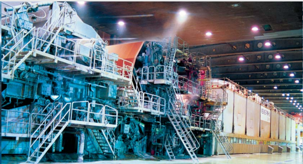
Мокрая часть бумагоделательной машины
